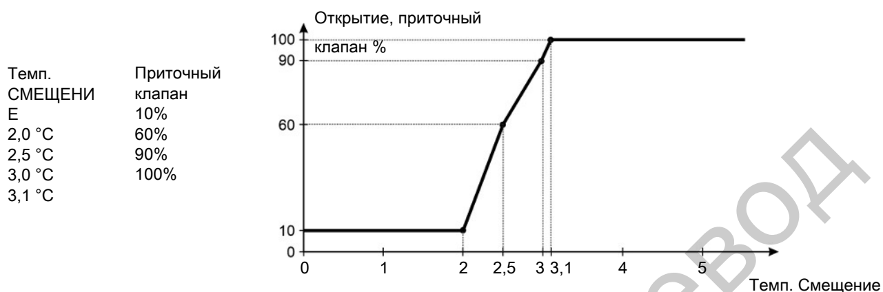
Рисунок 11: Комбидиффузный приточный клапан – бесступенчатое открытие согласно внутренней и внешней температуре
